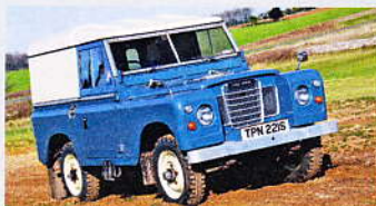
Serie III Mit geändertem Grill aus Plastik; der V8 debütiert und nimmt die Serie-IV-Optik vorweg
