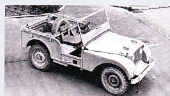
Centersteer-Landy Der Prototyp trägt das Lenkrad mittig, das Chassis spendet ein Jeep
