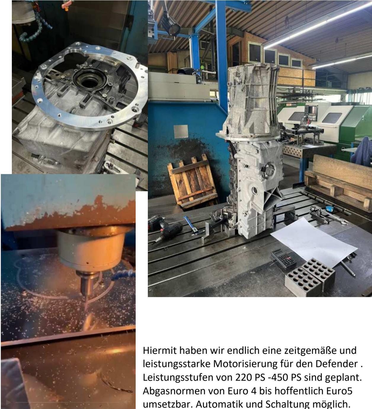
Hiermit haben wir endlich eine zeitgemäße und leistungsstarke Motorisierung für den Defender . Leistungsstufen von 220 PS -450 PS sind geplant. Abgasnormen von Euro 4 bis hoffentlich Euro5 umsetzbar. Automatik und Schaltung möglich.
