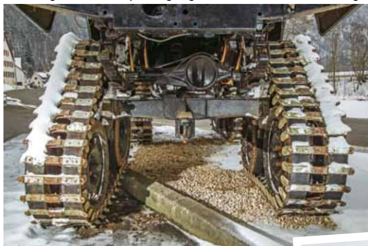
SUV à la Schottland: vier Kettensätze, Hilfsrahmen
