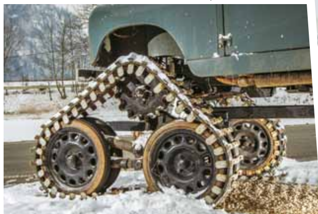
Speizen der unteren Zwillingräder spannt die Kette
