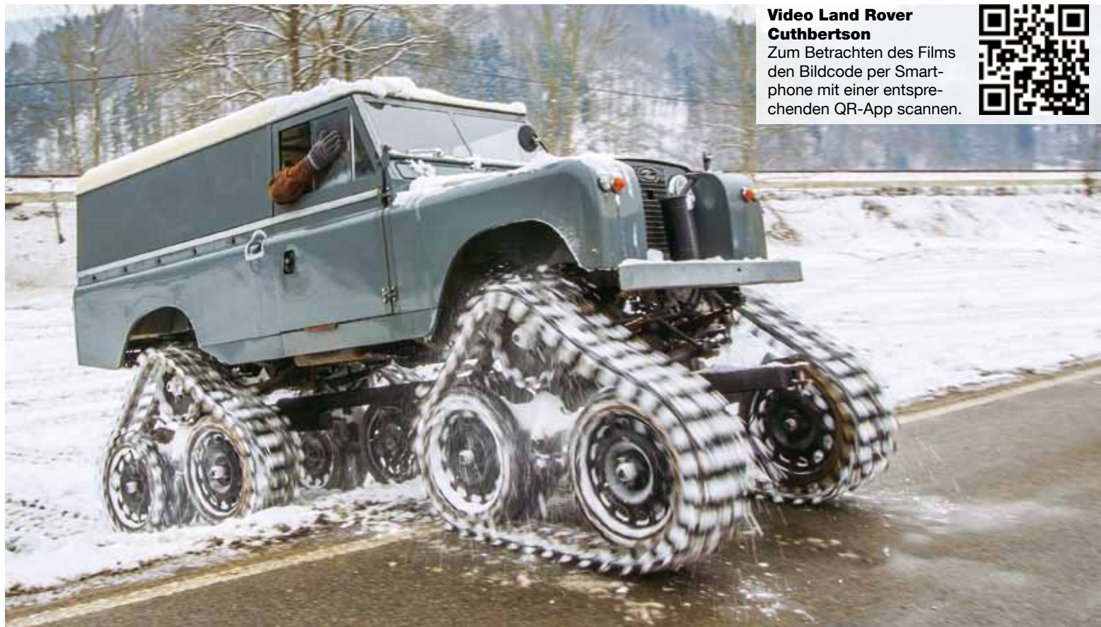
Zum Bergfahren nicht optimal geeignet: Die vordere Kettenführung ist nicht nach vorne angeschragt wie etwa bei einem Panzer
