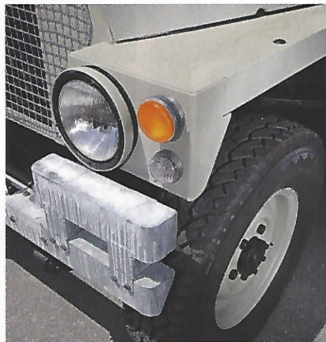
Viele Karosserieteile sind simpler als am normalen 88er-Landy. Canvas-Top als abnehmbare Plane
