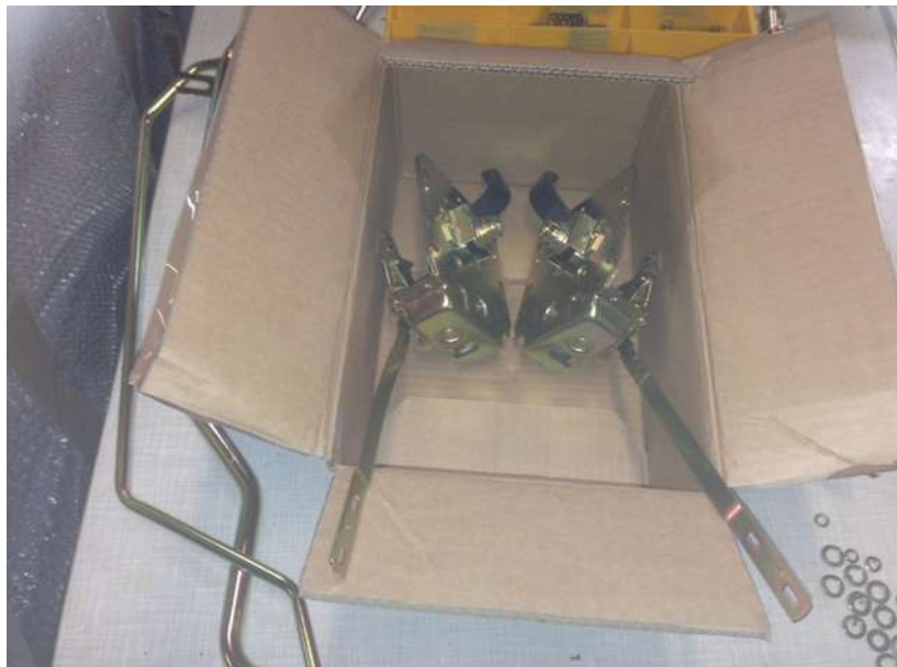
Auch die original alten Schlösser wurden überarbeitet und neu verzinkt. Diese Schlösser wurden nur für die ersten Defender Baujahre gebaut und sind nicht mehr erhältlich.
